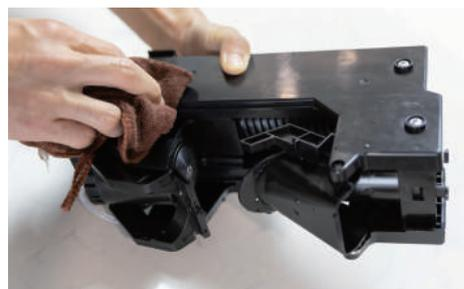
6. Trocknen Sie die Brühgruppe vollständig mit einem Tuch ab und lassen Sie sie vollständig trocknen, bevor Sie sie wieder einsetzen.
