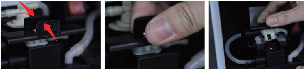
2. Drücken Sie auf den Sicherheitsverschluss und ziehen Sie die Milchaufschäumdüse nach oben.
