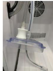
4. Stecken Sie den NTC und den integrierten Milchschauch in den Deckel des Milchbehälters.
