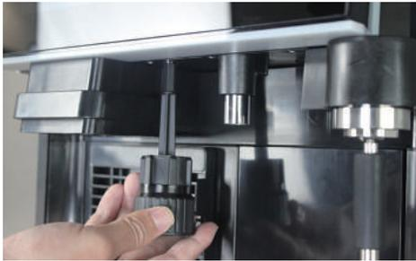
1. Verwenden Sie den Schlüssel, um das Bedienfeld zu entriegeln (falls erforderlich).
